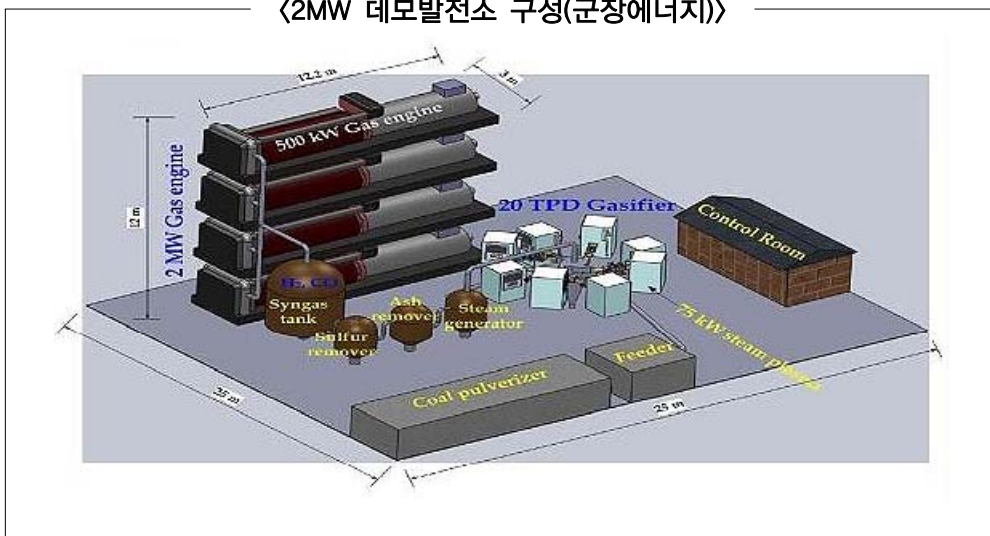
〈2MW 데모발전소 구성(군장에너지)〉
